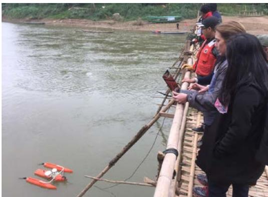
*El experto técnico de DOI-ITAP muestra cómo medir la descarga con un perfilador de corriente Doppler acústico. Luang Prabang, Laos (RDP), 11 de enero de 2018.*
